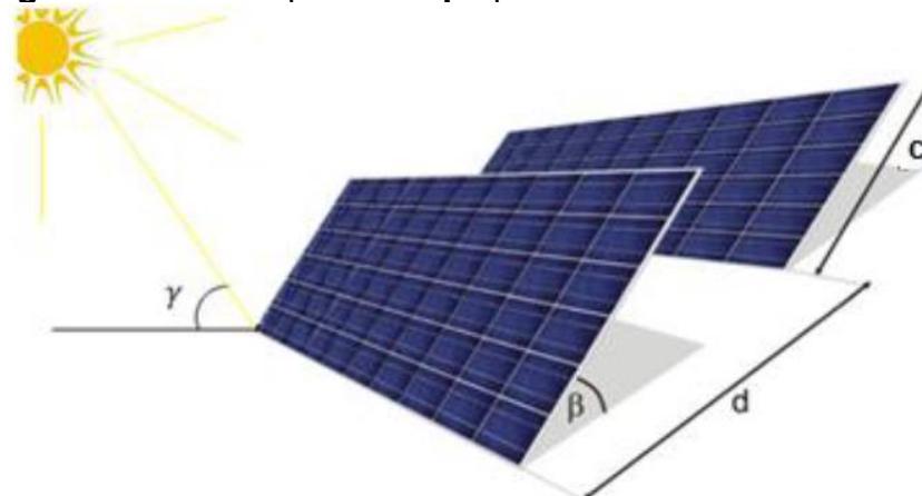
Figura 37 - Indicação do espaçamento mínimo entre fileiras
