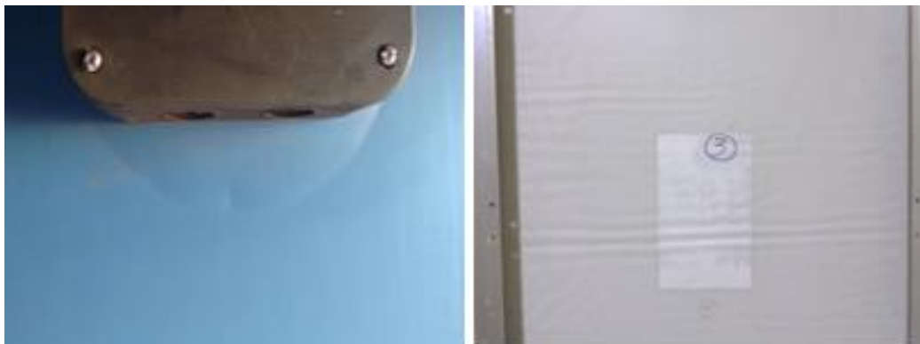
Figura 55 - Módulos degradados devido a deformações no backsheet
