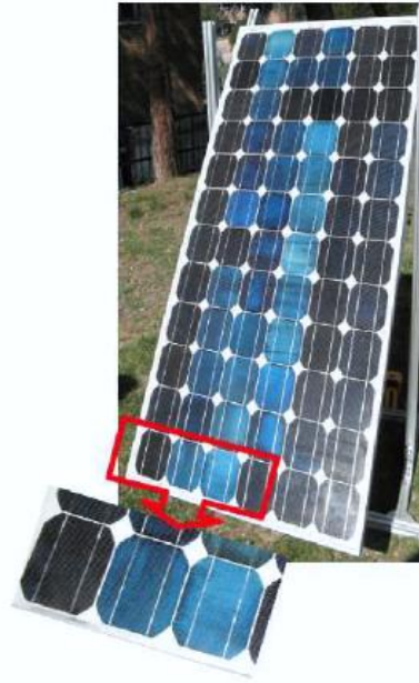
Figura 18 - Alterações na coloração da camada AR em células solares
