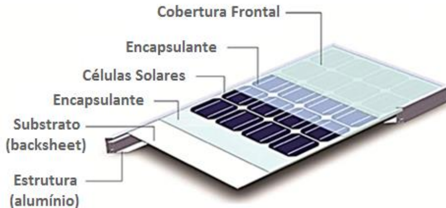
Figura 5 - Módulo fotovoltaico com células solares de Silício cristalino
