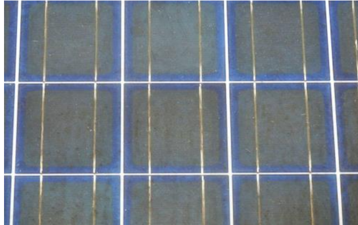
Figura 13 - Módulo fotovoltaico comprometido pelo browning
